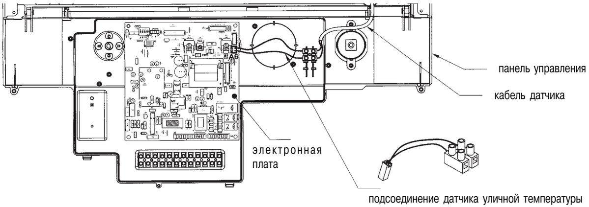
Если к котлу подсоединен датчик уличной температуры, регулятор температуры контура отопления работает как регулятор коэффициента дисперсии Kt.
