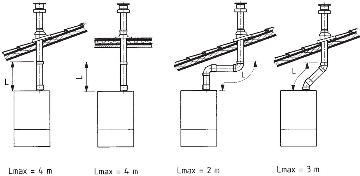
Данная установка может быть выполнена как на наклонной, так и на плоской крыше путем закрепления наконечника с соответствующей погодной насадкой (дополнительная арматура заказывается отдельно).
