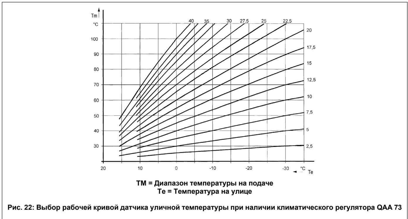
Рис. 22: Выбор рабочей кривой датчика уличной температуры при наличии климатического регулятора QAA 73
