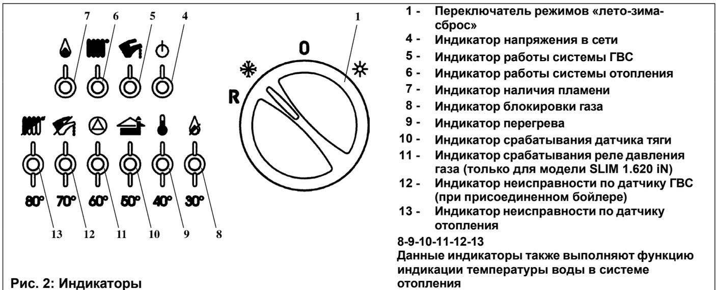
«Немигающие» индикаторы 8-13 отражают температуру в системе отопления.
