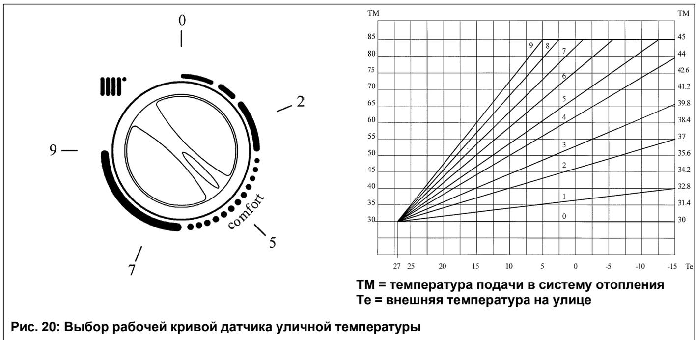
**Внимание:** Значение температуры подачи в систему отопления TM зависит от положения переключателя T.RISC на плате (см. § 13). Максимальное значение устанавливаемой температуры равно 85 или 45°C (по умолчанию установлено 85°C).
