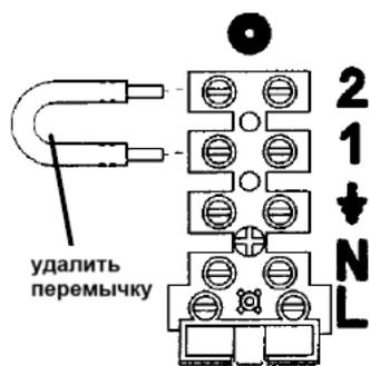
Присоединение регулятора по протоколу OpenTherm представлено на рис. 21.
