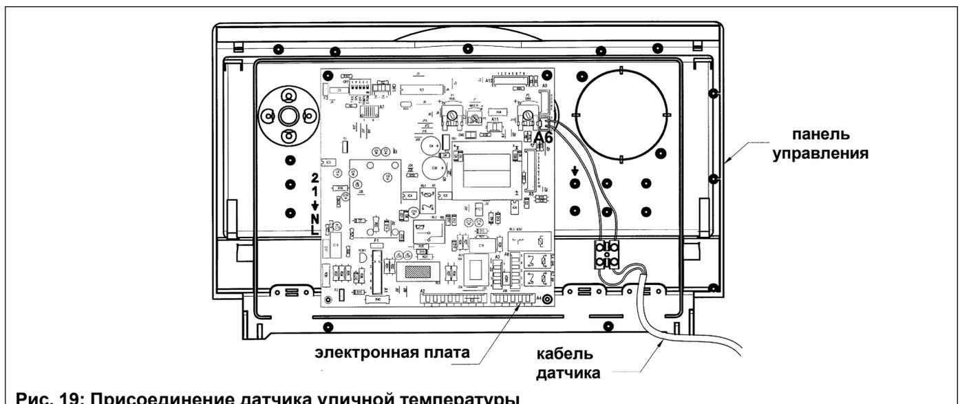
Рис. 19: Присоединение датчика уличной температуры
