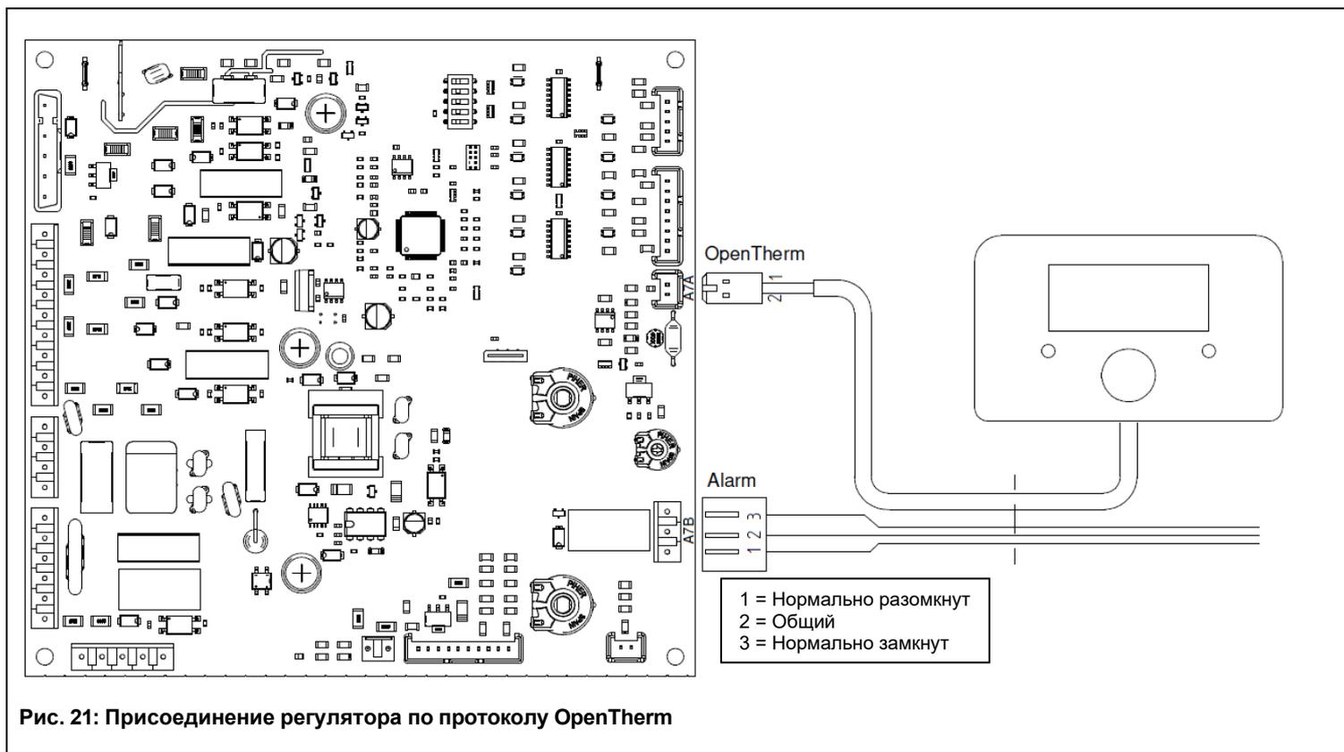
Рис. 21: Присоединение регулятора по протоколу OpenTherm
