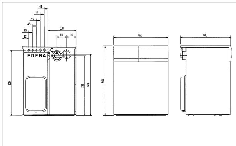
Рис. 4: Габаритные размеры для моделей 2.300 Fi
