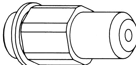
Рис. 33: Форсунка горелки
