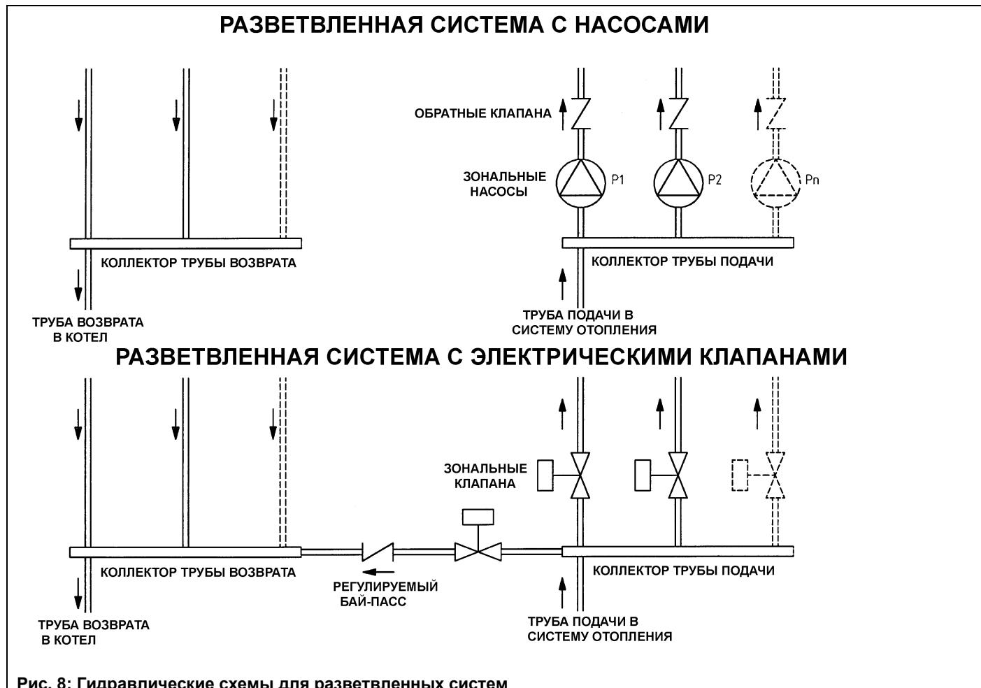
Рис. 8: Гидравлические схемы для разветвленных систем
