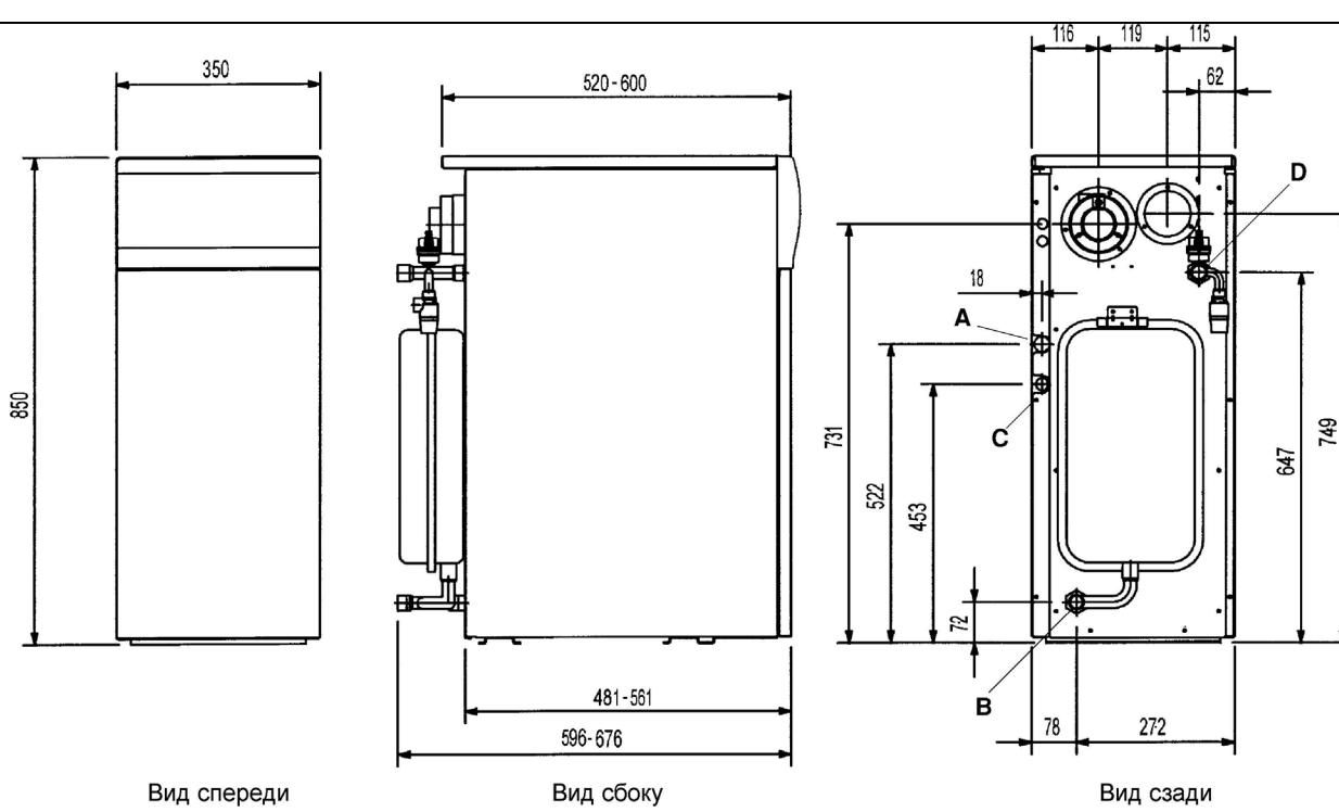
**Рис. 7: Габаритные размеры для моделей 1.230 Fi, 1.300 Fi**
