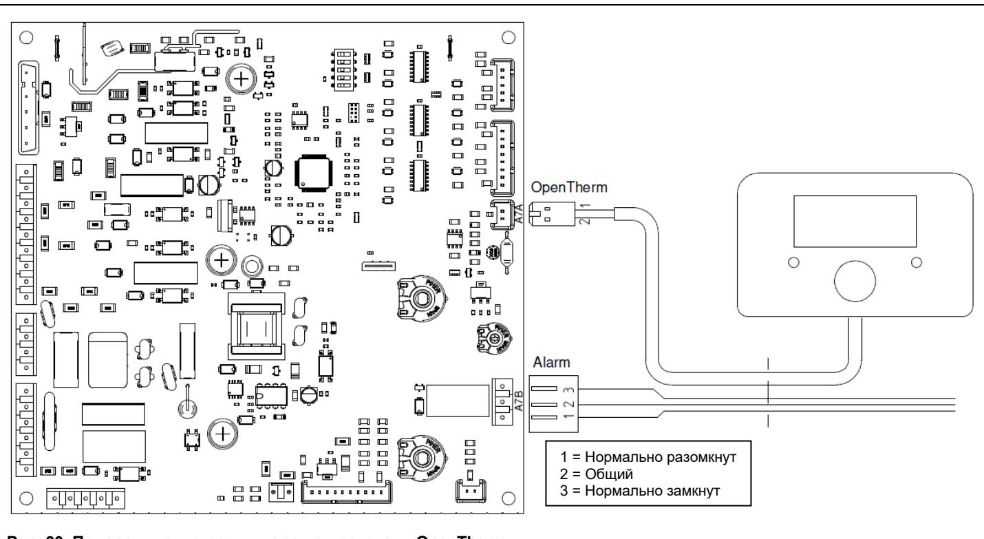
Рис. 30: Присоединение регулятора по протоколу OpenTherm
