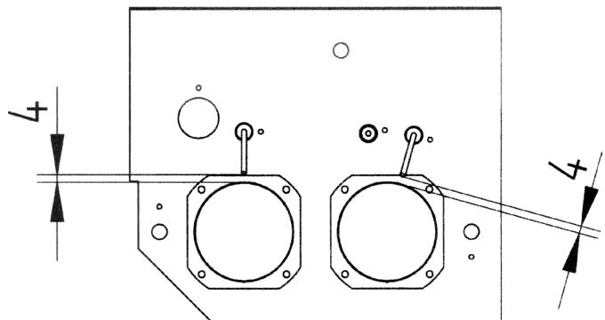
**Рис. 34 Расположение электродов зажигания**
