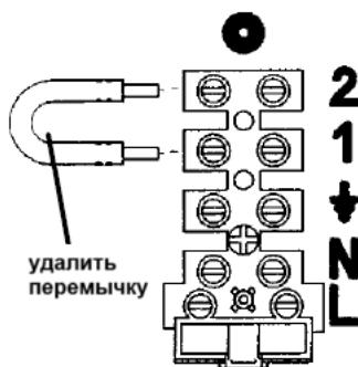
Присоединение регулятора по протоколу OpenTherm представлено на рис. 30.
