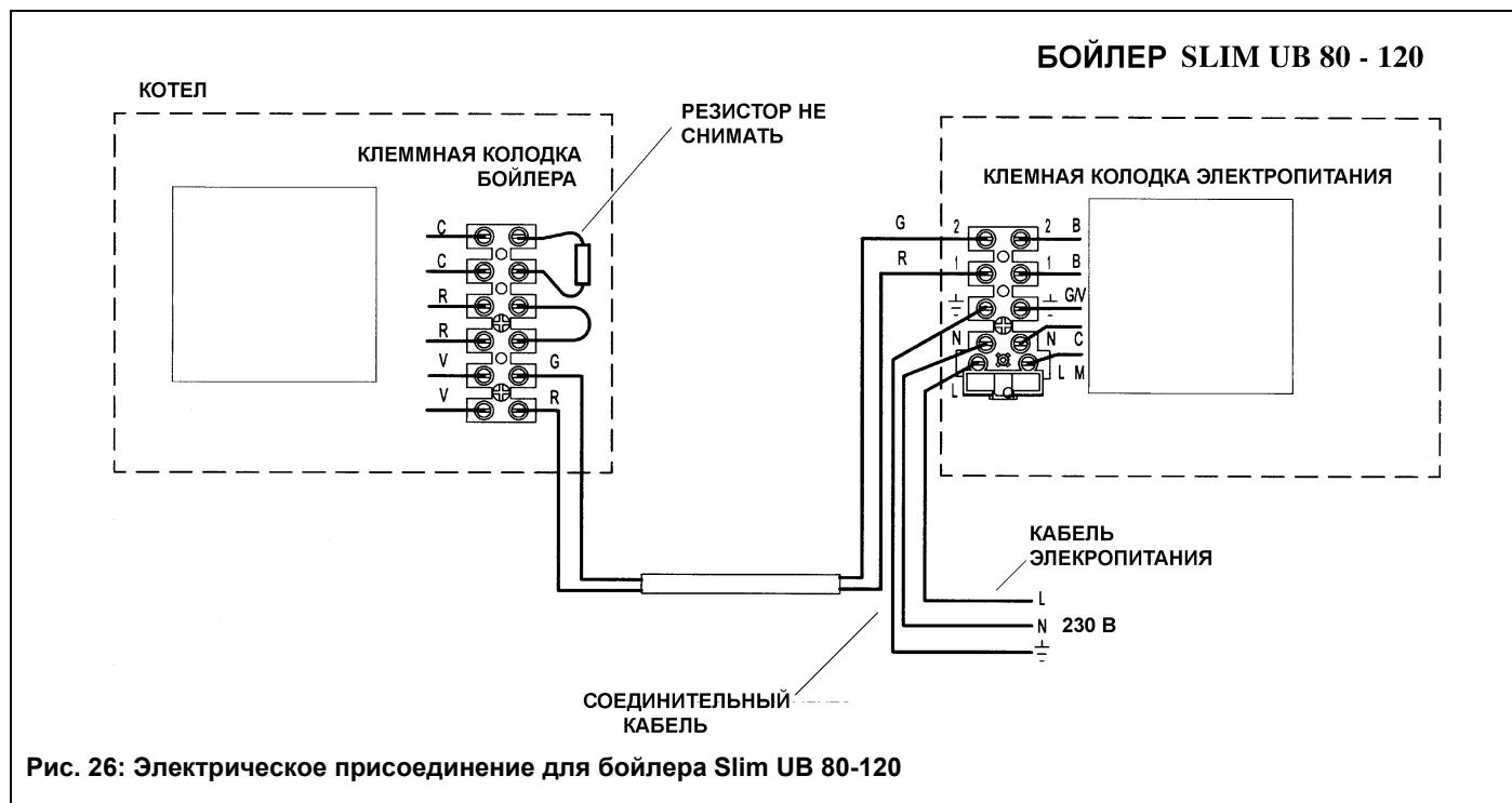
Рис. 26: Электрическое присоединение для бойлера Slim UB 80-120
