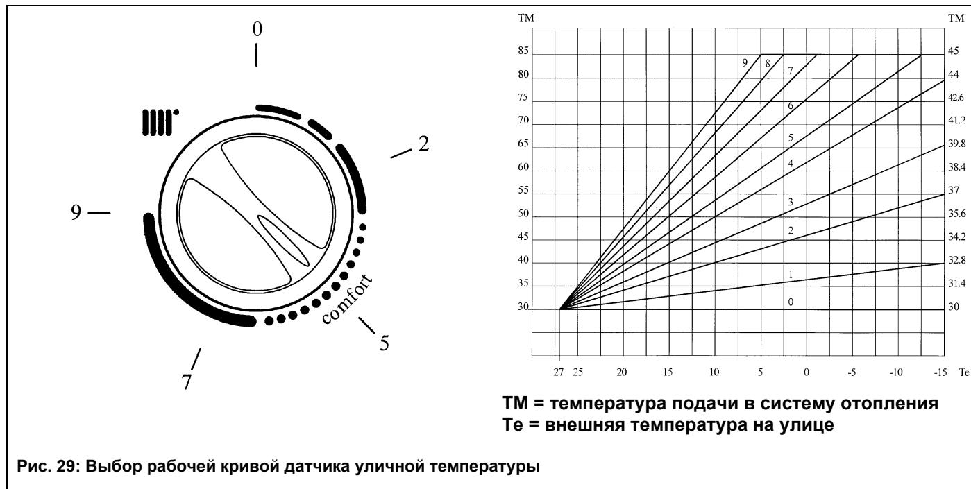
Рис. 29: Выбор рабочей кривой датчика уличной температуры
