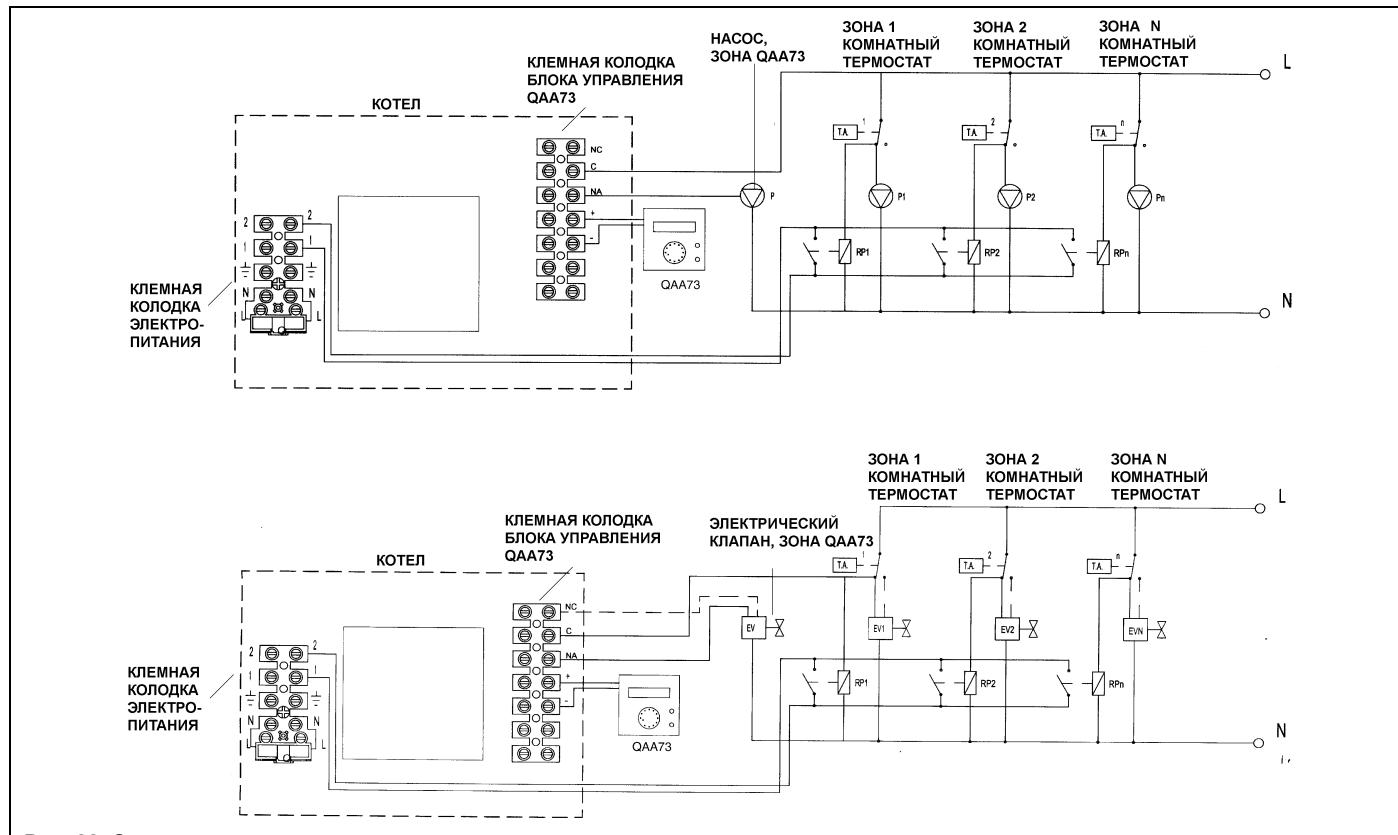
Рис. 22: Электрические схемы присоединения зональных комнатных термостатов и подачи питания на насосы и клапана
