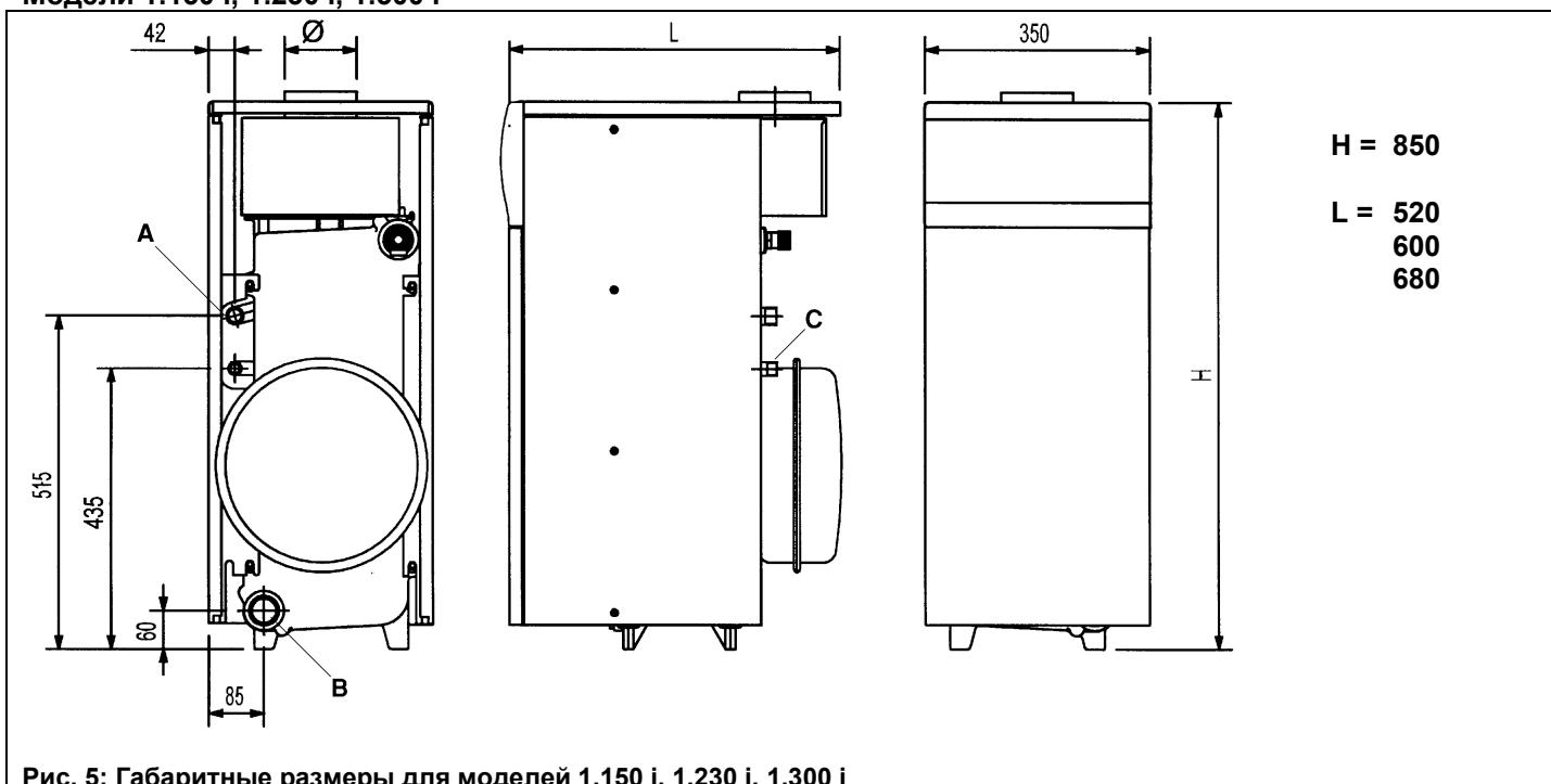
Рис. 5: Габаритные размеры для моделей 1.150 i, 1.230 i, 1.300 i
