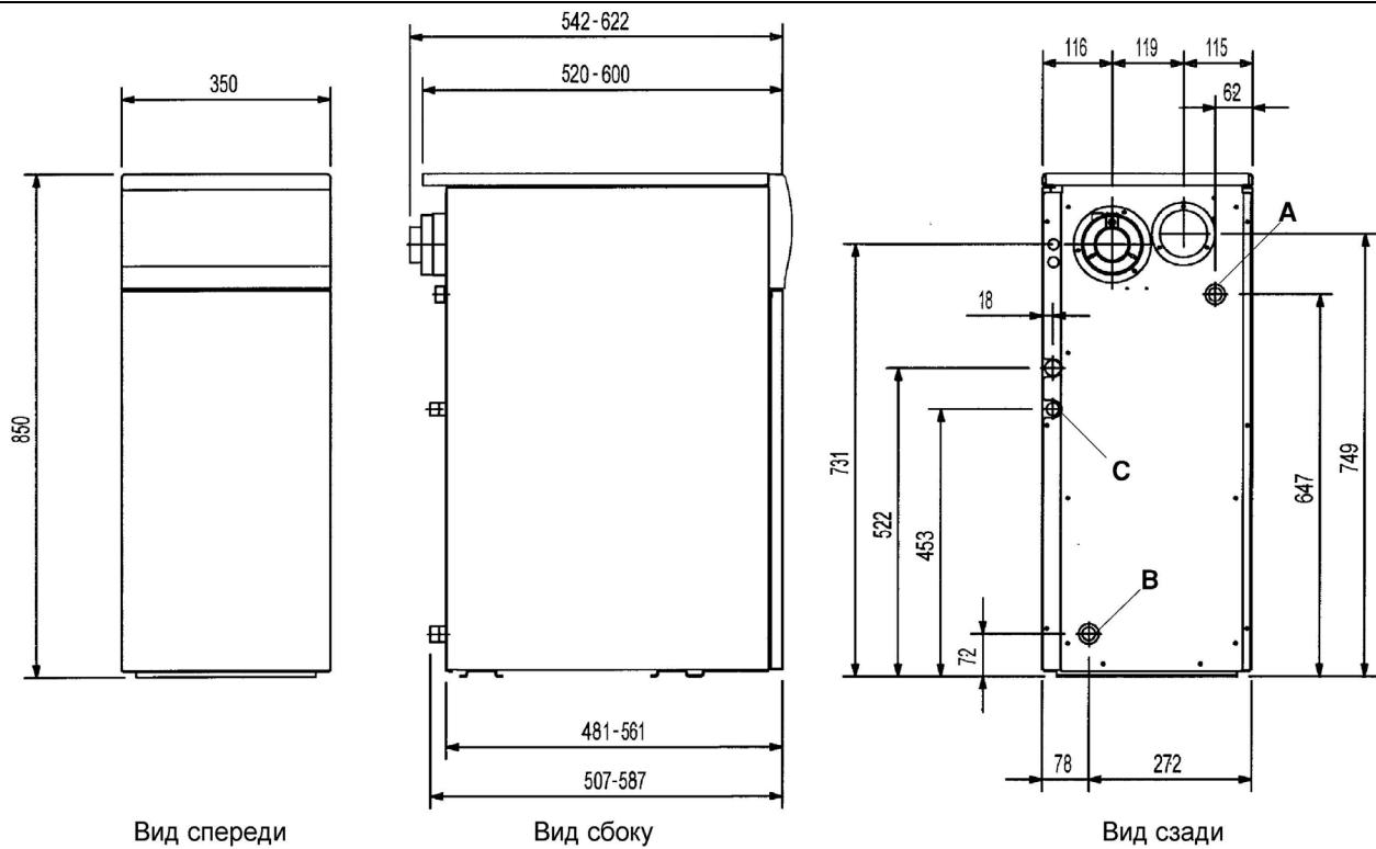
**Рис. 6: Габаритные размеры для моделей 1.230 FiN, 1.300 FiN****Модели 1.230 Fi, 1.300 Fi**
