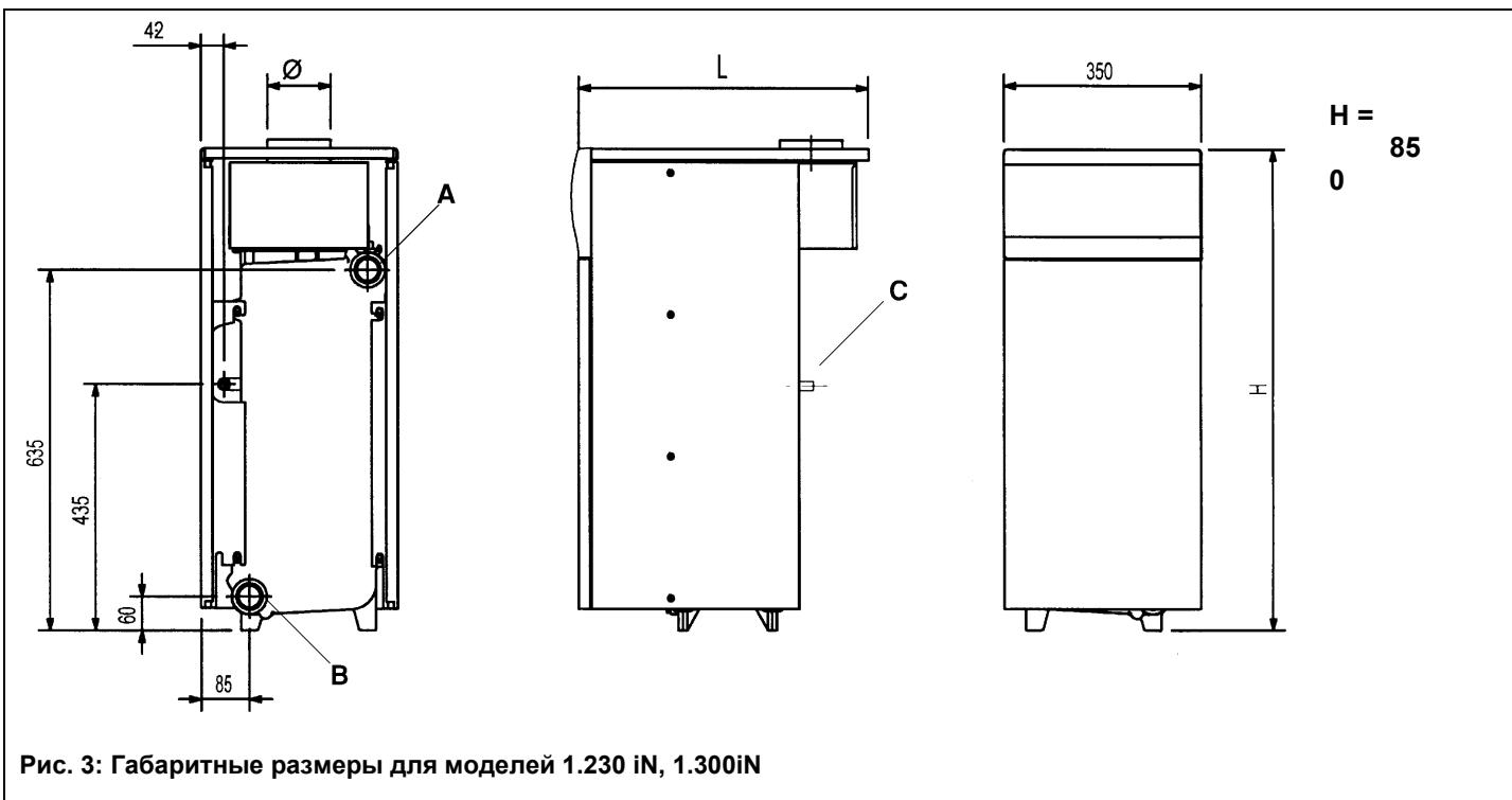
Рис. 3: Габаритные размеры для моделей 1.230 iN, 1.300iN
