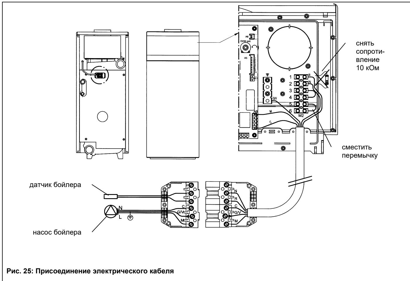
Рис. 25: Присоединение электрического кабеля
