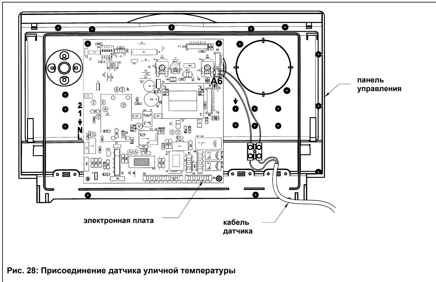
Рис. 28: Присоединение датчика уличной температуры
